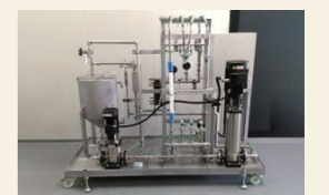
耐溶剤性分離膜プロセスのテスト機
